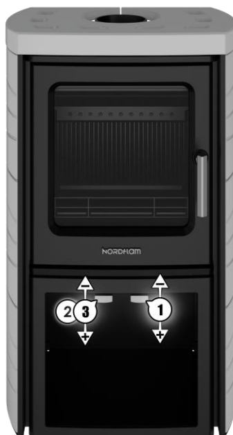
Rys. 5. [PL] Regulacja dopływu powietrza/ [CZ] Regulace přívodu vzduchu/ [HU] Légbeáramlás szabályozása/ [SK] Nastavenie prívodu vzduchu/ [EN] Adjustment of air supply/ [LT] Oro tiekimo reguliavimas/ [LV] Gaisa padeves regulēšana/ [RU] Регулировка подачи/ [EE] Õhuvastustuse reguleerimine/ [GR] Ρύθμιση παροχής αέρα/ [RO] Ajustarea alimentării cu aer/ [BG] Регулиране на подаването на въздух/ [UA] Регулювання подачі повітря/ [NL] Afstellen van de luchttoevoer/ [HR] Regulacija dovoda zraka/ [TR] Hava beslemesinin ayarı/ [PT] Regulação da entrada de ar/ [FR] Réglage de l'arrivée d'air/ [ES] Ajuste del suministro de aire
