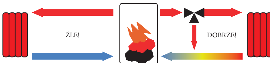
Rys. 34. Zastosowanie zaworu mieszającego
