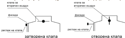
Фиг. 4. Пример за регулиране на въздушния поток към пещта (предна страна на)
