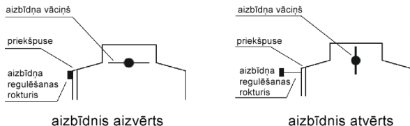
Att. 5 Aizbīdņa regulēšanas piemērs.
