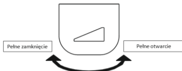
Rys. 5. Przykładowa regulacja dopływu powietrza do paleniska
