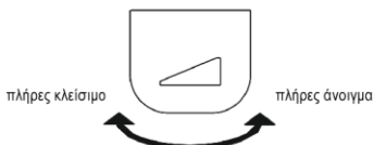
Σχ. 4. Παράδειγμα ρύθμισης της παροχής αέρα στην εστία (άποψη της πρόσωσης του σταχτοδοχείου)
